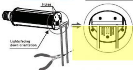
La béquille, livrée avec la lampe, peut être coupée à la longueur souhaitée pour prendre appui sur le globe du lampadaire ou le déflecteur du projecteur, permettant ainsi de soulager la douille.
